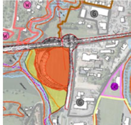
Abbildung 29: Überflutungsfläche, Variante 3f
