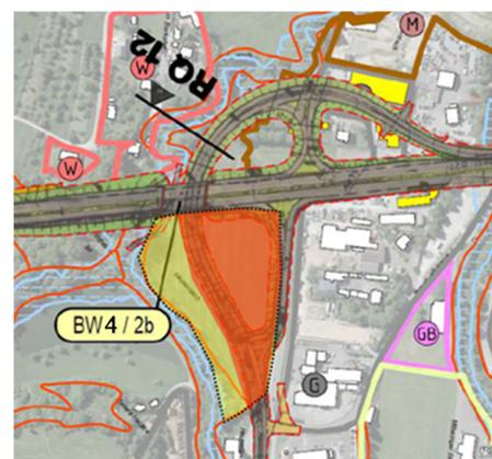
Abbildung 17: Überflutungsfläche, Variante 2b
