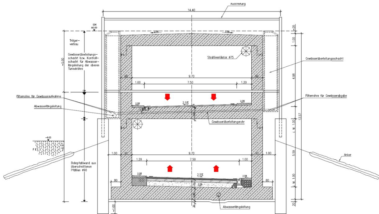
Abbildung 18: Systemdarstellung Tunnelquerschnitt Variante 3b
