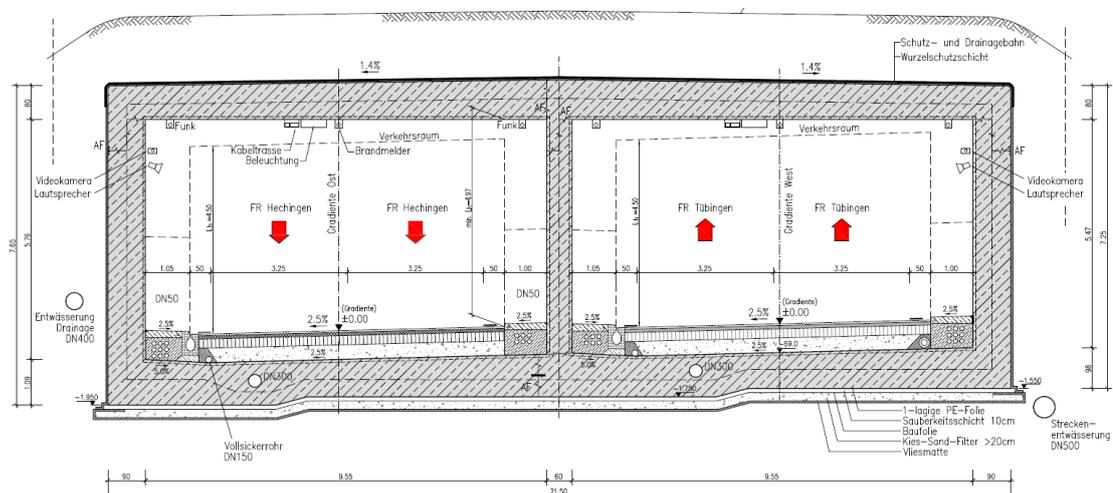
Abbildung 7: Systemdarstellung Tunnelquerschnitt, Variante 2a
