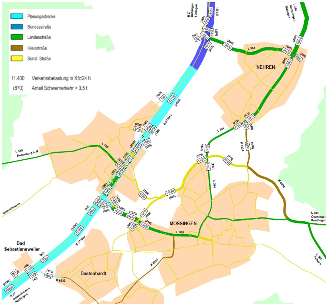
Abbildung 27: Ergebnisse der Verkehrsumlegungsrechnungen für Variante 3f (2019)
