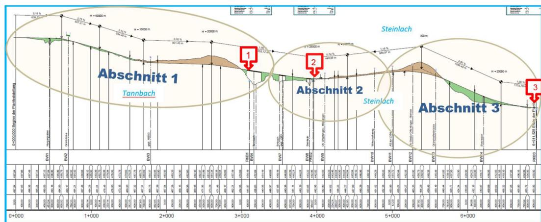
Abbildung 39: Lage der Tiefpunkte im Aufriss der Trasse
