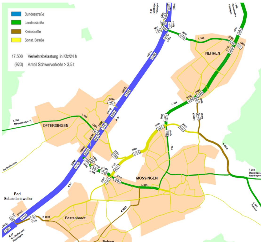
**Abbildung 4: Prognose-Nullfall 2030 - Verkehrsbelastung DTW<sub>WS</sub>**
