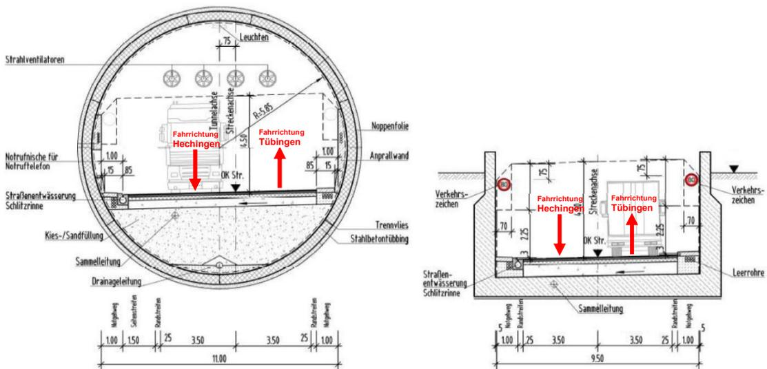
Abbildung 25: Systemdarstellung Tunnelquerschnitt, Variante 3f (einbahniger Tunnel)
