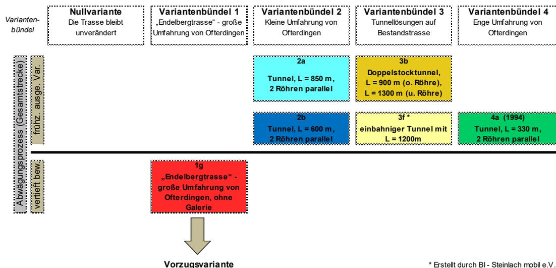
Abbildung 2: Frühzeitig ausgeschiedene und vertieft untersuchte Variante
