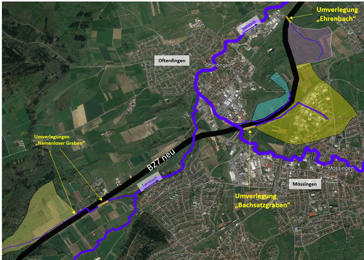
*Abb. 1a: Übersichtslageplan zum „Namenlosen Graben“ und Bachsatzgraben (jeweils Verlegung) sowie zum „Abfanggraben NW“ (Neuerstellung)*
