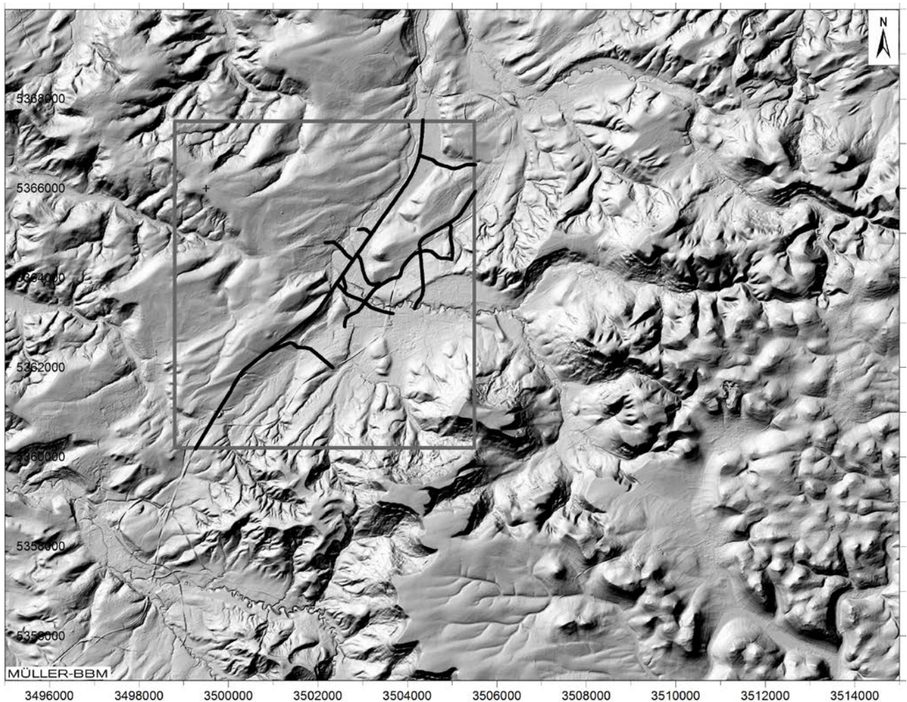
Abbildung 9. Geländere relief [6] für den Nullfall im erweiterten Klam21-Rechengebiet mit Abgrenzung des LASAT-Rechengebiets (Achsenbeschriftung Gauß-Krüger-Koordinaten).
