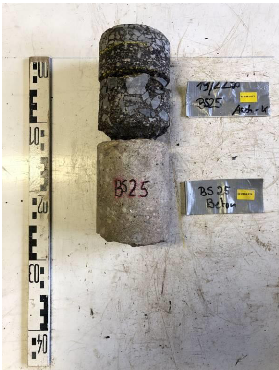
Bild 9: BS 25/19, Kernstücke K1 und K 2 (Beton)
