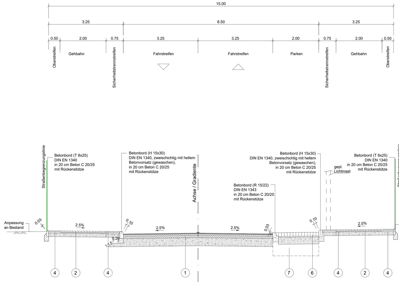
1 Befestigungsaufbau Fahrbahn
