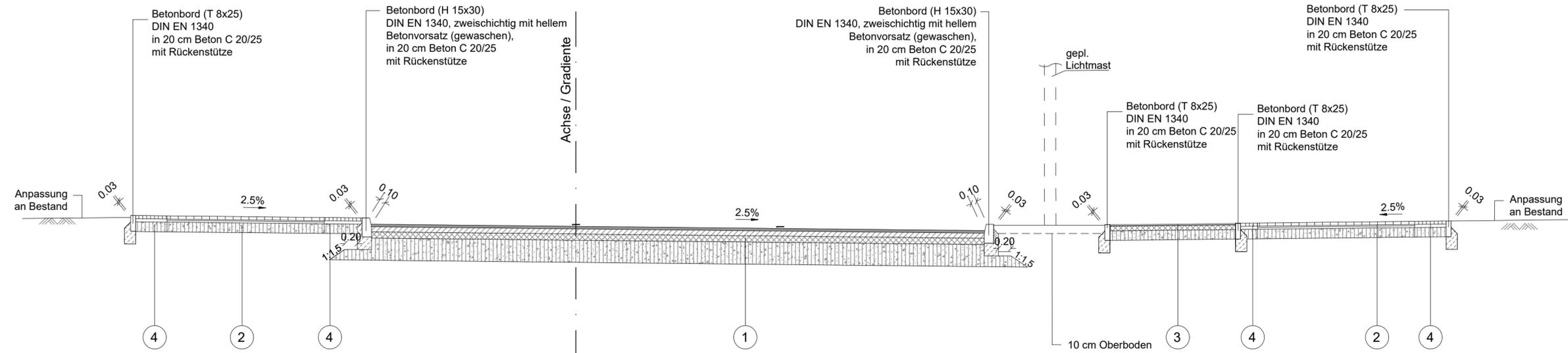
1 Befestigungsaufbau Fahrbahn
