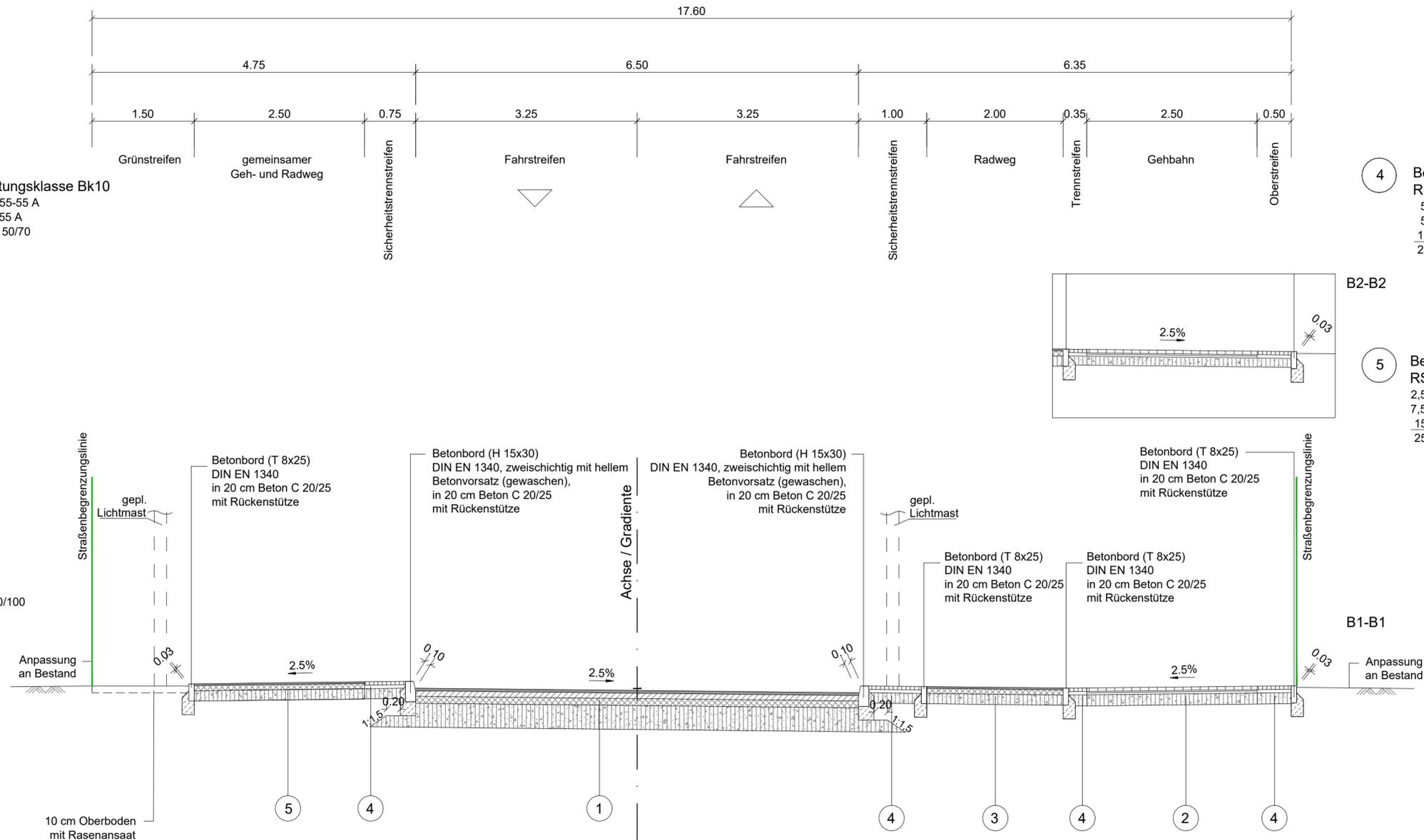
1 Befestigungsaufbau Fahrbahn
