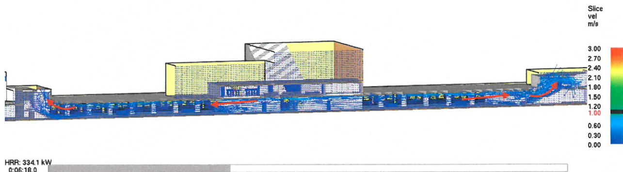
Abbildung 42: Strömungssituation nach 6,3 Minuten – Vertikalschnitt y = 0,6\text{ m}
