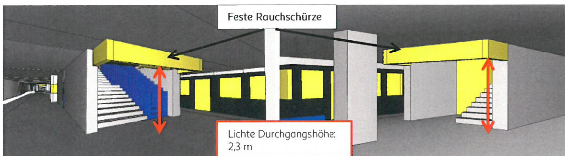
Abbildung 16: Darstellung der Rauchschürzen (links am östlichen Ausgang zur Schalterhalle, rechts am westlichen)
