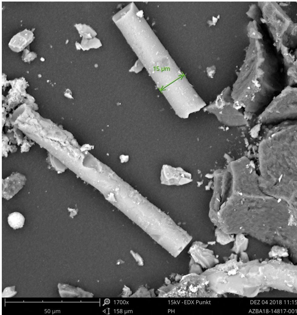
Bild 3: Detailaufnahme Aluminiumsilikatwollefasern, nicht lungengängig
