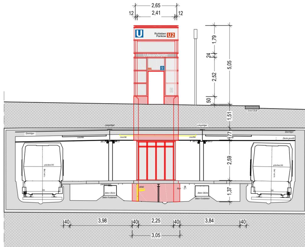
Ansicht West - Querschnitt A - A (M 1:100)
