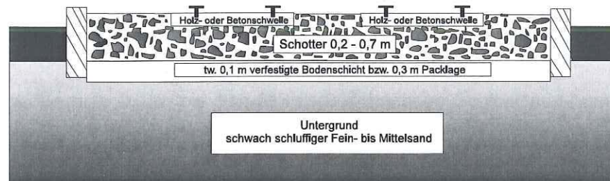
Bild 8: Angetroffene Ober- und Unterbauverhältnisse (offener Oberbau)
