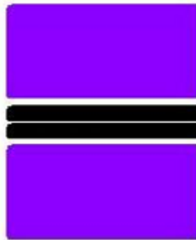
Abb. A2.2: Schematische Darstellung der Quelllage „Drittellage“. Gebäude sind lila, die beiden Straßenquellen sind schwarz gekennzeichnet.
