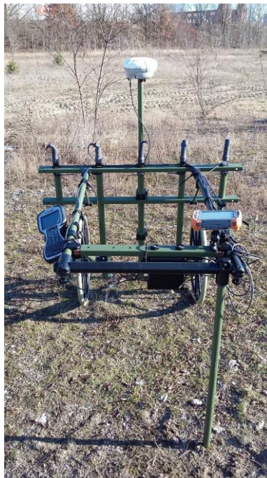
Abb. 11: Zur Mehrkanalsondierung verwendetes Gradiometersystem (FGM 650 der Fa. SENSYS)
