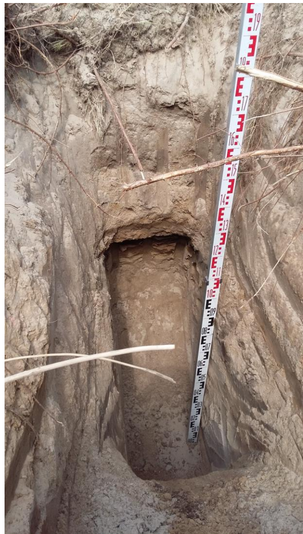
Abb. 25: Baggerschurf 12, Bereich Werkstatthalle, anthropogene Auffüllung von 0,3-1,9 m u. GOK
