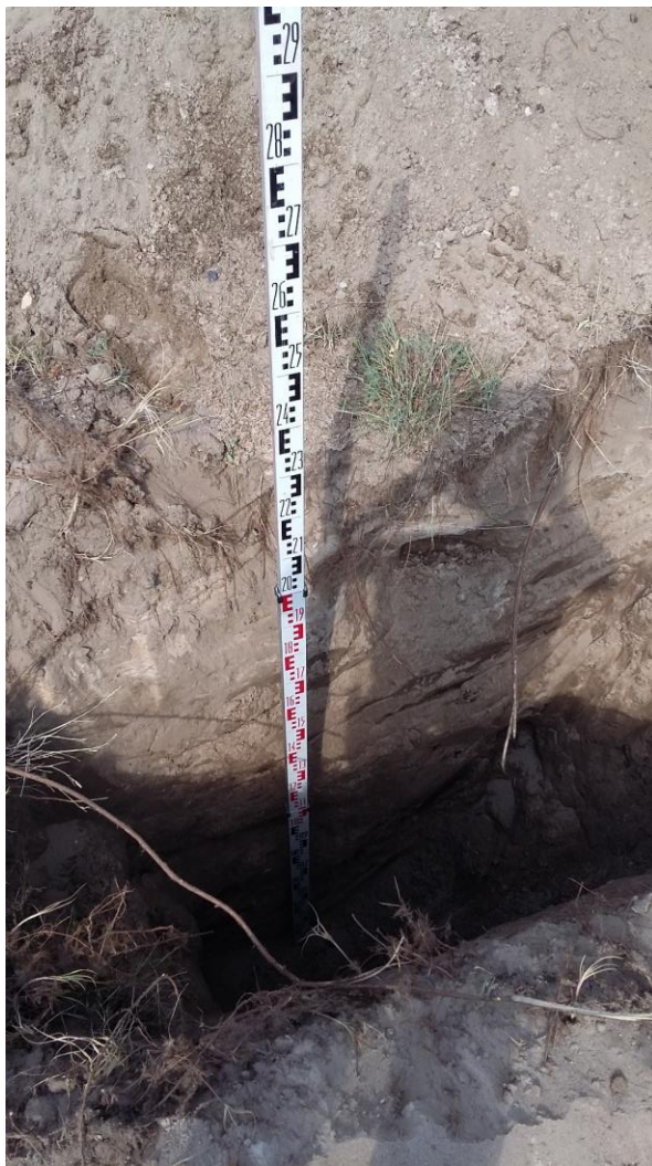
Abb. 24: Baggerschurf 11, Bereich Werkstatthalle, anthropogene Auffüllung von 0,2-1,9 m u. GOK
