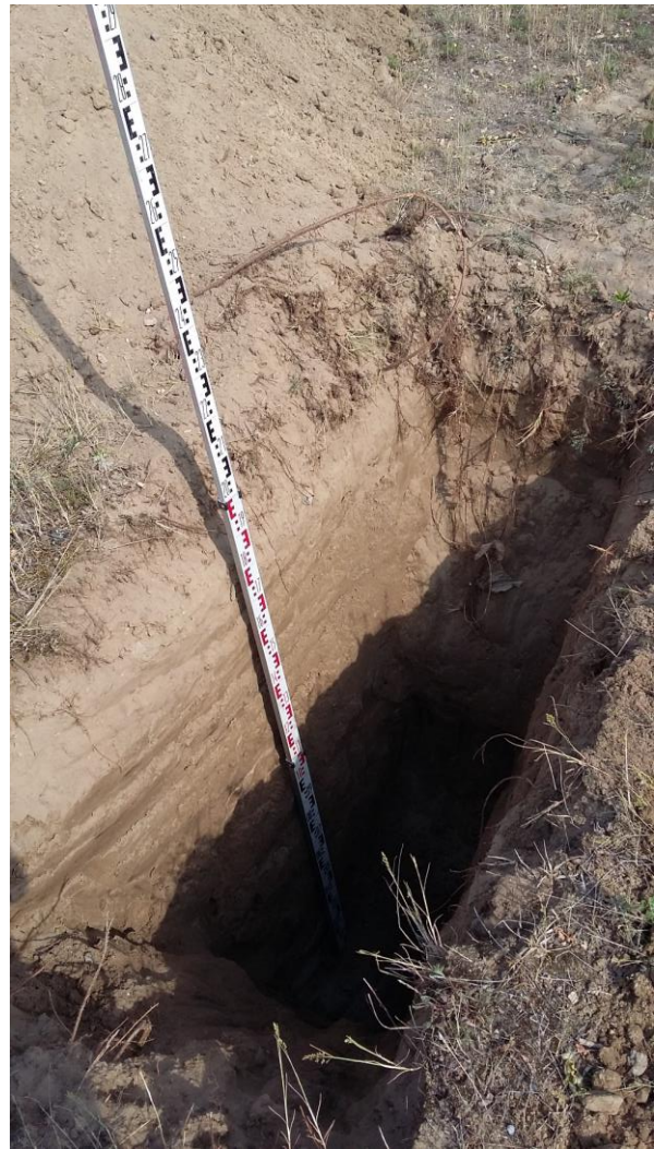
Abb. 23: Baggerschurf 10, Bereich Werkstatthalle, anthropogene Auffüllung von 0,3-2,0 m u. GOK
