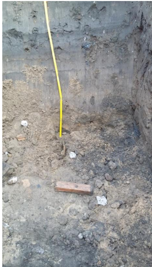
Abb. 17: Baggerschurf 4, anthropogene Auffüllung unterhalb der RC-Schicht in der Nähe des Bahndamms. Bildmitte: alter Kabelschacht. Unterhalb Zollstock: Beton mit Bewehrung
