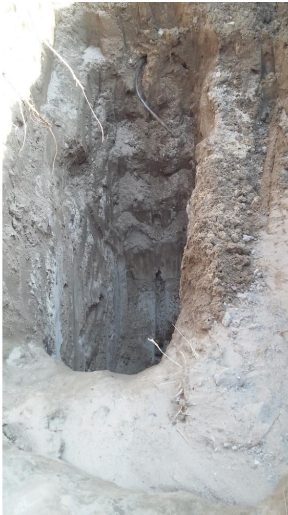
Abb. 22: Baggerschurf 9, Bereich Werkstatthalle, anthropogene Auffüllung von 0,25-2,0 m u. GOK
