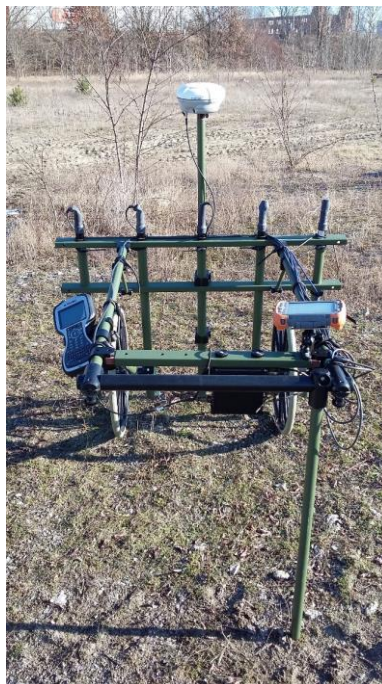
Abb. 6: Zur Mehrkanalsondierung verwendetes Gradiometersystem (FGM 650 der Fa. SENSYS)
