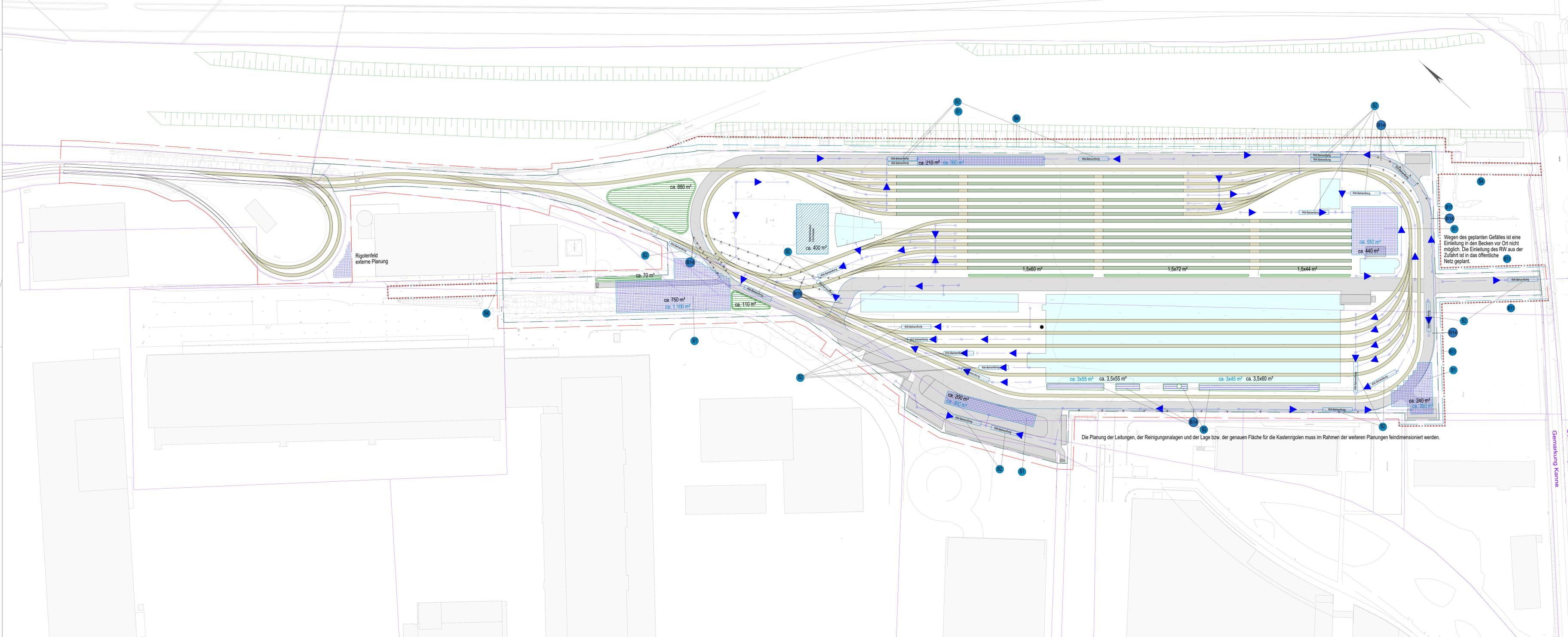
Wegen des geplanten Gefälles ist eine Einleitung in den Becken vor Ort nicht möglich. Die Einleitung des RW aus der Zufahrt ist in das öffentliche Netz geplant.
