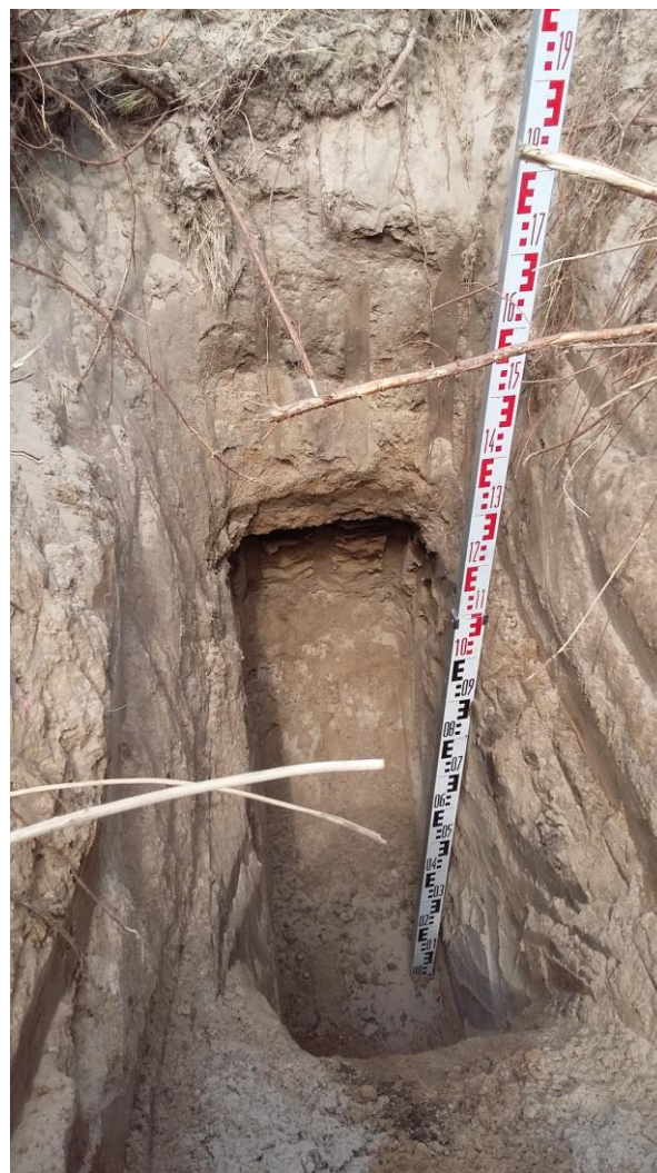
Abb. 25: Baggerschurf 12, Bereich Werkstatthalle, anthropogene Auffüllung von 0,3-1,9 m u. GOK
