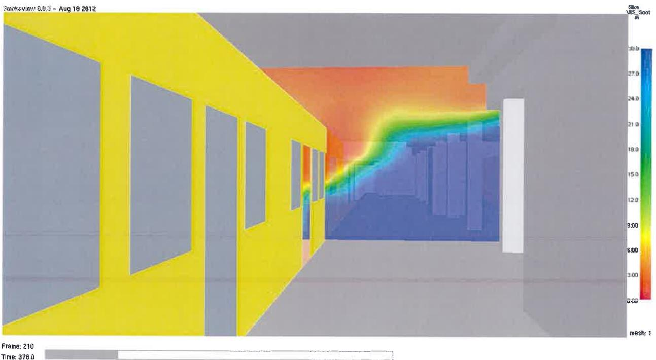
Abb. 43 **Erkennungsweite in m** zum Zeitpunkt  $t = 479$  Sekunden (8,0 Minuten = Evakuierungszeit) im Vertikalschnitt durch den Brandherd und Bahnhof. Das Schutzziel wird erfüllt.
