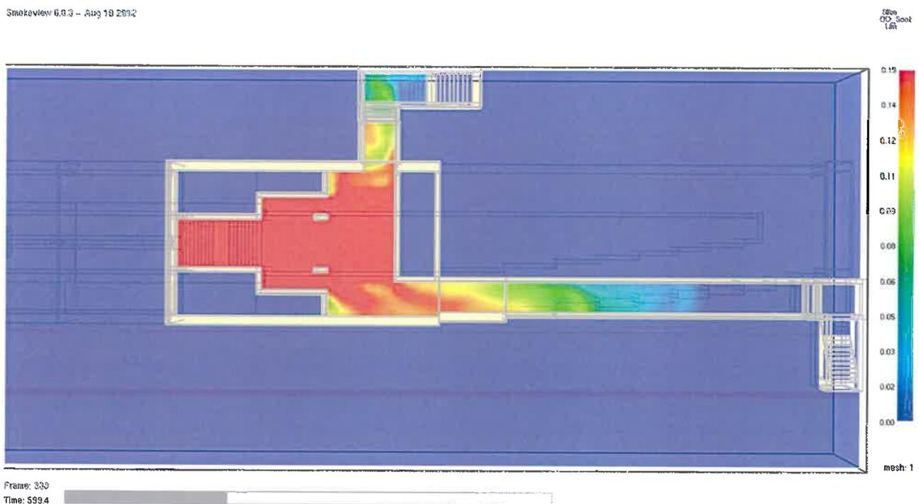
**Abb. 45** *Optische Rauchdichte in 1/m zum Zeitpunkt  $t = 600$  Sekunden im Horizontalschnitt in 2,0 m Höhe über dem Fußboden der Schalterhalle I. Ab ca. diesem Zeitpunkt ist der größte Bereich der Schalterhalle verraucht. Die Ausgänge sind noch nutzbar.*
