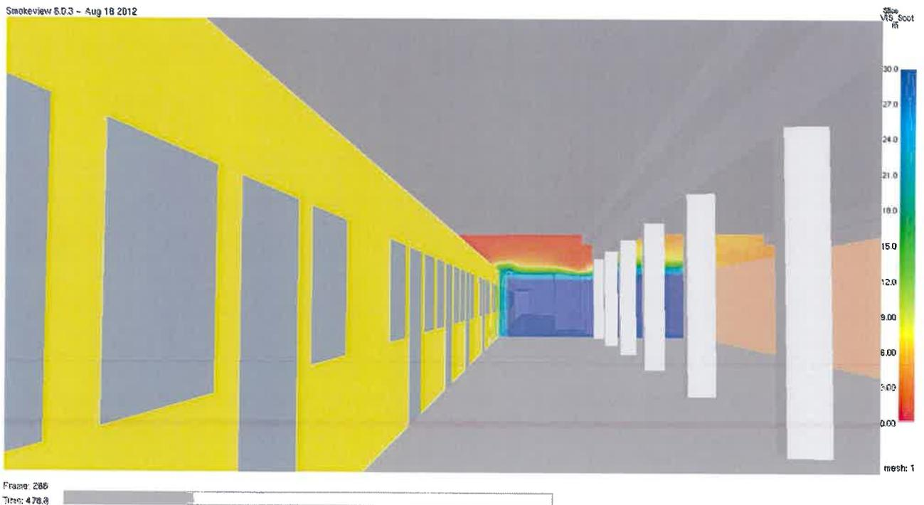
Abb. 28 **Erkennungsweite in m** zum Zeitpunkt  $t = 479$  Sekunden (8,0 Minuten = Evakuierungszeit) im Vertikalschnitt durch den Brandherd und Bahnhof. Das Schutzziel wird erfüllt.
