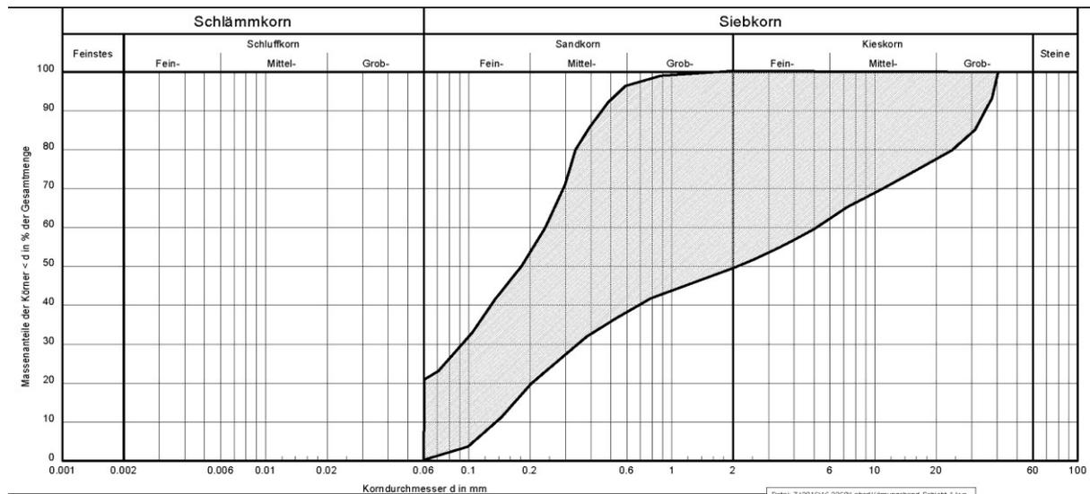
**Abb. 1: Körnungsband Schicht 1 Aufschüttung/ Dammschüttung**
