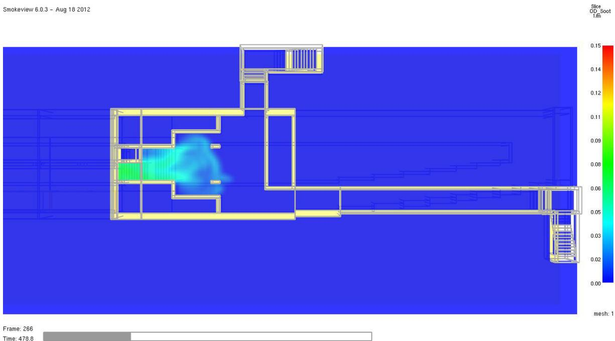
Abb. 25 **Optische Rauchdichte** in 1/m zum Zeitpunkt **t = 479 Sekunden** (8,0 Minuten = Evakuierungszeit) im Horizontalschnitt in 2,0 m Höhe über dem Fußboden der **Schalterhalle I**. Der Grenzwert von 0,15 1/m wird nicht erreicht. Das Schutzziel wird zu diesem Zeitpunkt vollumfänglich erfüllt. Die flüchtenden Personen befinden sich zu diesem Zeitpunkt im Freien.
