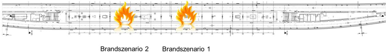
*Abb. 14      Position des brennenden Triebwagens für Szenario 1 und 2*
