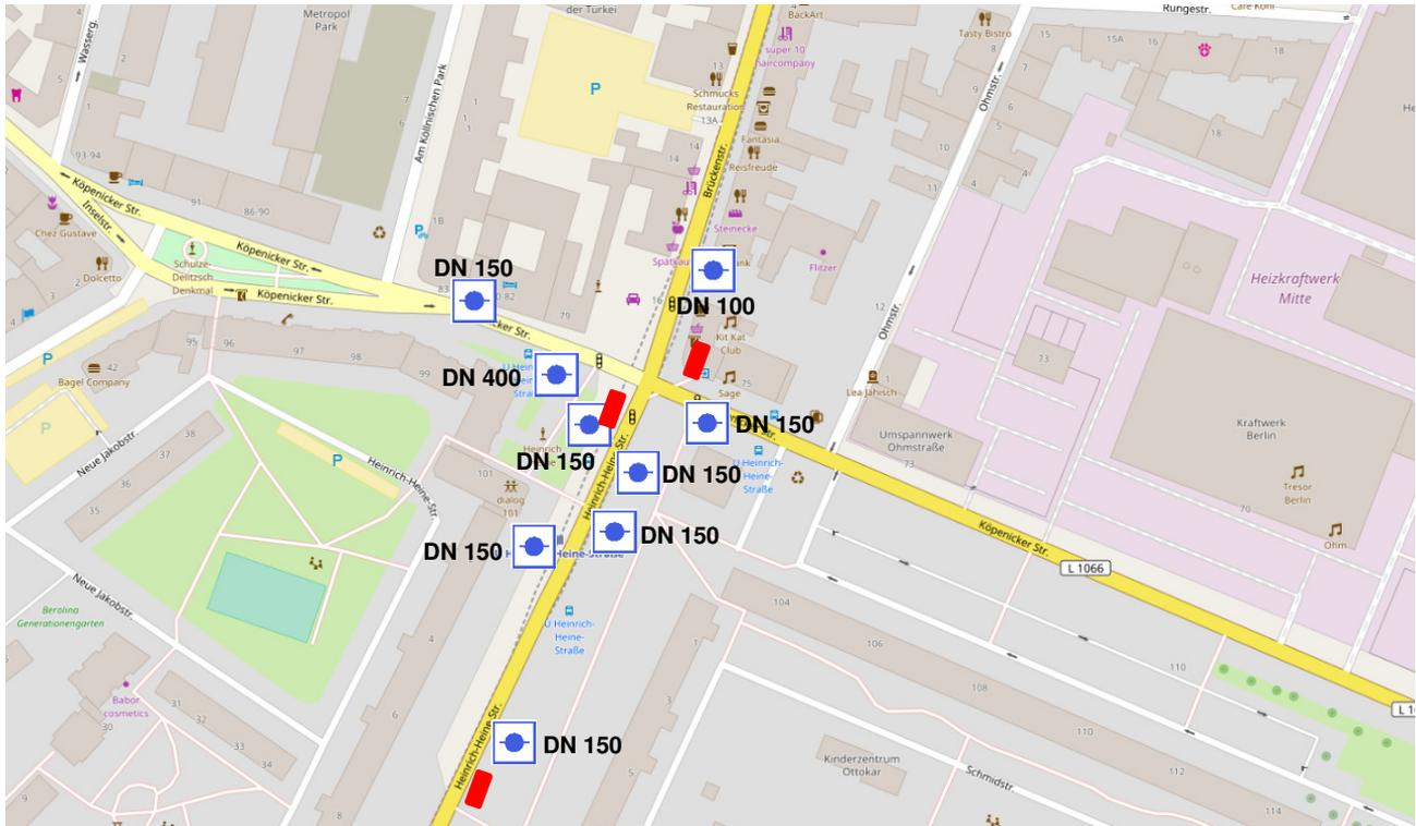
**Abb. 35:** Übersicht der in der Umgebung des U-Bahnhof Heinrich-Heine-Straße festgestellten Unterflurhydranten (
