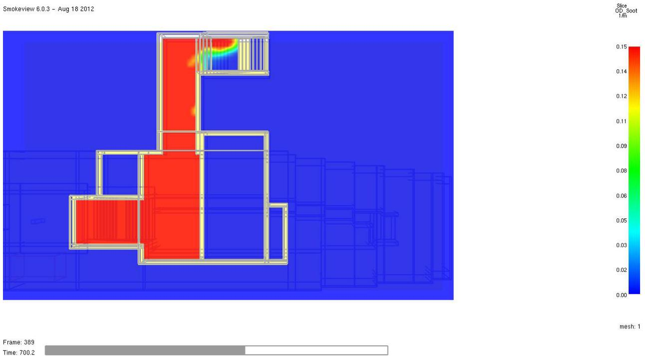
Abb. 62 **Optische Rauchdichte** in 1/m zum Zeitpunkt **t = 700 Sekunden** im Horizontalschnitt in 2,0 m Höhe über dem Fußboden der **Schalterhalle II**. Ab ca. diesem Zeitpunkt ist der größte Bereich der Schalterhalle verraucht. Der Ausgang ist gerade noch nutzbar.
