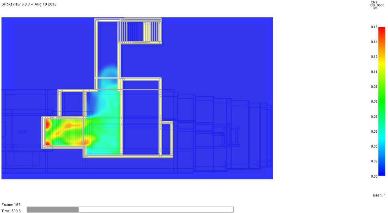
**Abb. 35** *Optische Rauchdichte in 1/m zum Zeitpunkt  $t = 300$  Sekunden im Horizontalschnitt in 2,0 m Höhe über dem Fußboden der **Schalterhalle II**. Das Schutzziel wird zu diesem Zeitpunkt erfüllt. Lediglich oberhalb der Treppenanlage zum Bahnsteig wird der Grenzwert punktuell erreicht.*
