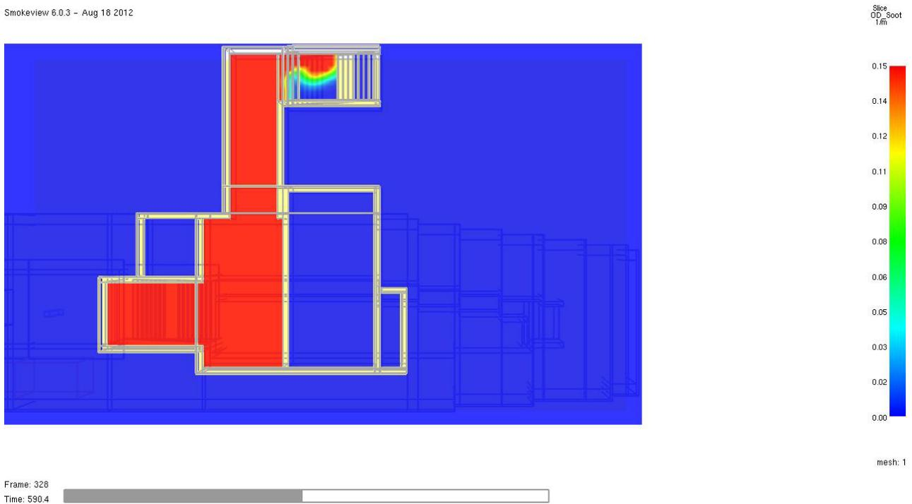
Abb. 32 **Optische Rauchdichte** in 1/m zum Zeitpunkt **t = 590 Sekunden** im Horizontalschnitt in 2,0 m Höhe über dem Fußboden der **Schalterhalle II**. Ab ca. diesem Zeitpunkt ist der größte Bereich der Schalterhalle verraucht. Der Ausgang ist gerade noch nutzbar.
