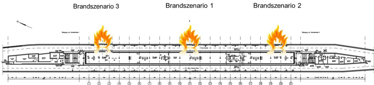
Abb. 14 Position des brennenden Triebwagens für Szenario 1, 2 und 3
