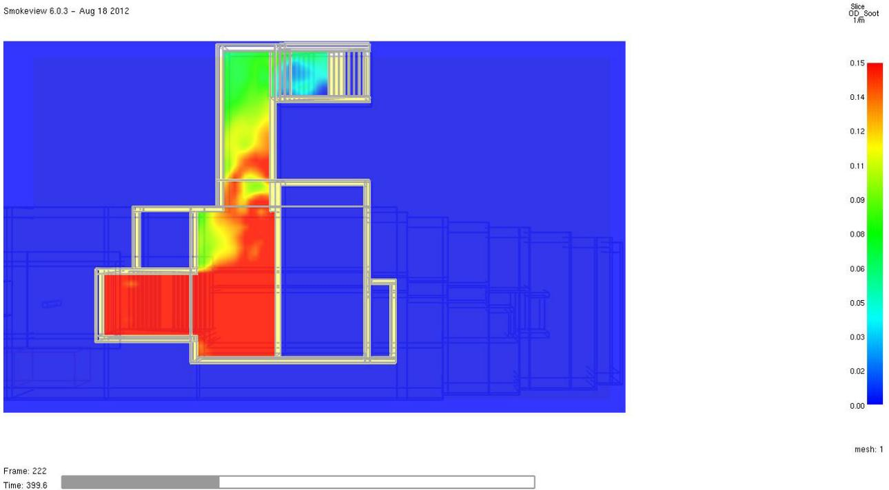
**Abb. 41** *Optische Rauchdichte* in 1/m zum Zeitpunkt **t = 399 Sekunden** (6,7 Minuten = Evakuierungszeit) im Horizontalschnitt in 2,0 m Höhe über dem Fußboden der **Schalterhalle II**. Der Grenzwert von 0,15 1/m wird in großen Bereichen der Ebene erreicht. Die flüchtenden Personen befinden sich aber zu diesem Zeitpunkt bereits im Freien.
