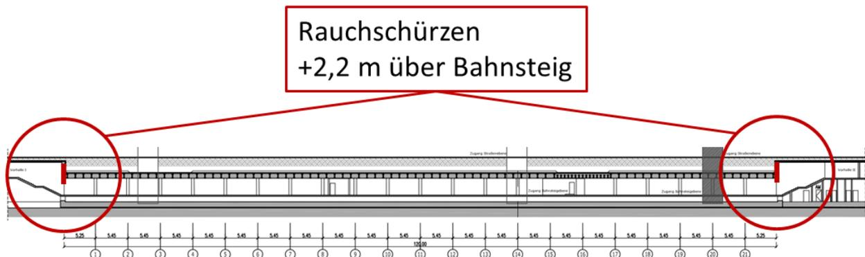
Abb. 10 neue Rauchschürzen an den Treppenaufgängen in die Schalterhallen
