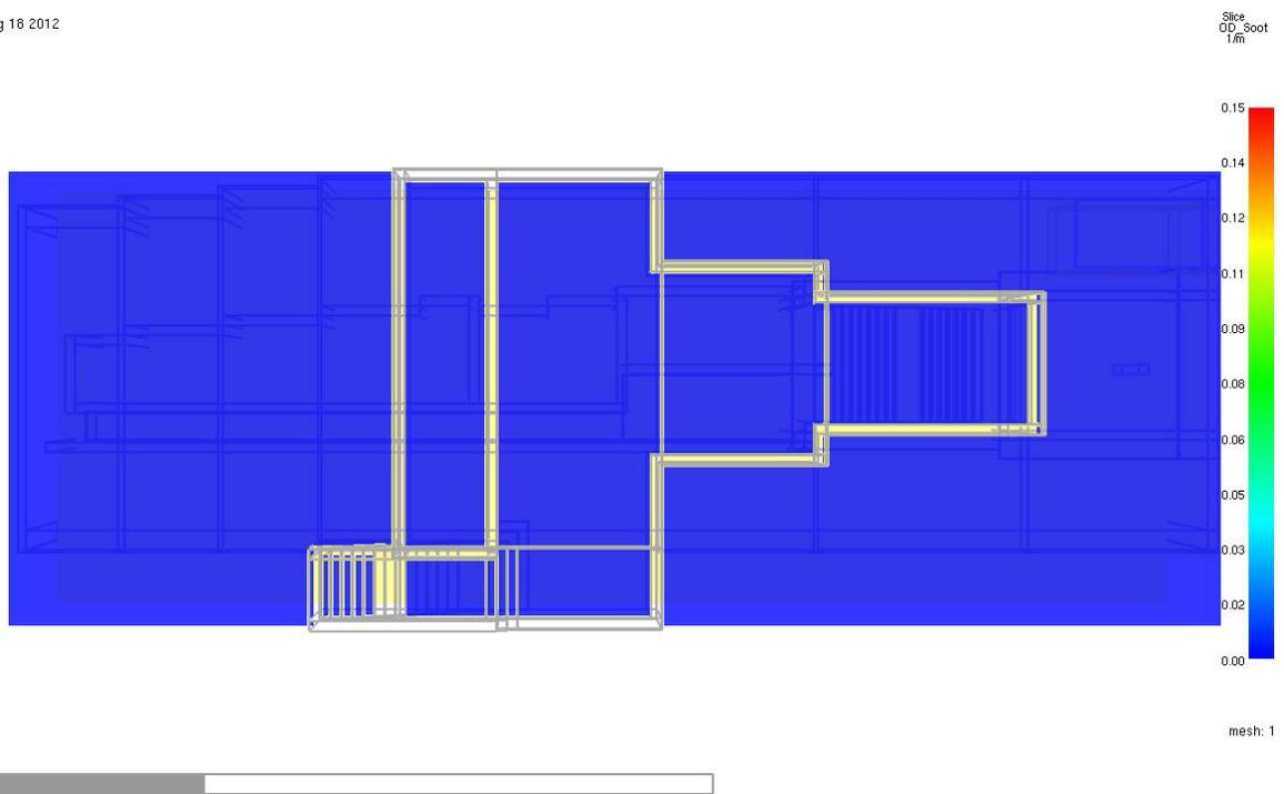
**Abb. 40** *Optische Rauchdichte* in 1/m zum Zeitpunkt **t = 399 Sekunden** (6,7 Minuten = Evakuierungszeit) im Horizontalschnitt in 2,0 m Höhe über dem Fußboden der **Schalterhalle I**. Das Schutzziel wird vollumfänglich erfüllt. Die flüchtenden Personen befinden sich zu diesem Zeitpunkt schon im Freien.
