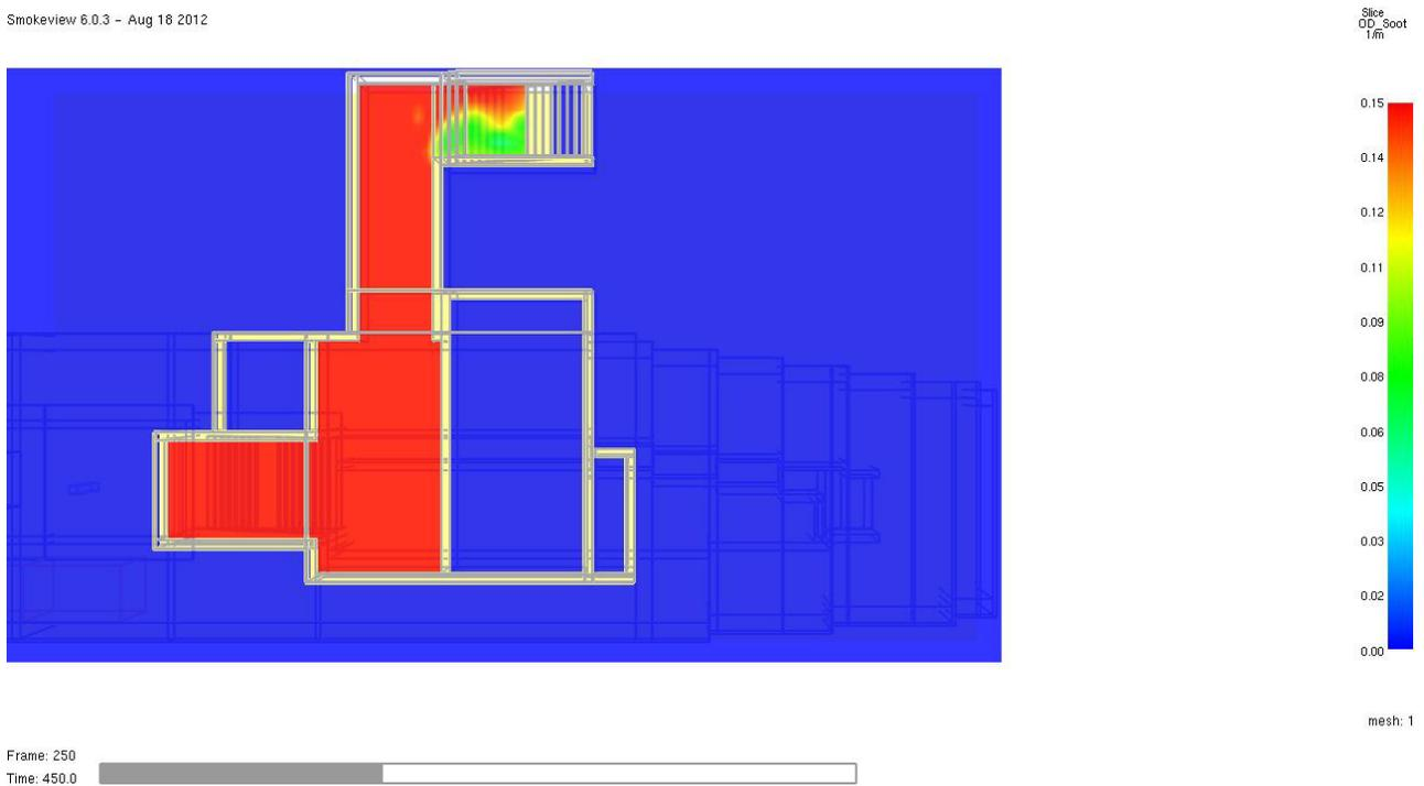
Abb. 47 **Optische Rauchdichte** in 1/m zum Zeitpunkt **t = 450 Sekunden** im Horizontalschnitt in 2,0 m Höhe über dem Fußboden der **Schalterhalle II**. Ab ca. diesem Zeitpunkt ist der größte Bereich der Schalterhalle verraucht. Der Ausgang ist gerade noch nutzbar.
