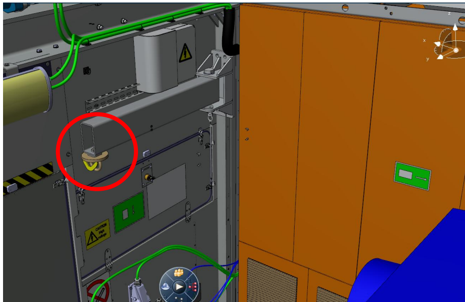
Abbildung 9: Beispielhafter Verankerungspunkt für die Notabseilvorrichtung in der Gondel
