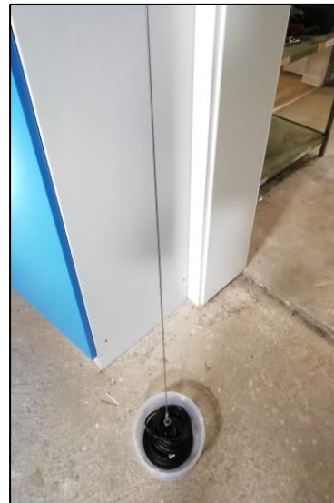
Abbildung 10-20: Autodachantenne mit Magnetfuß
