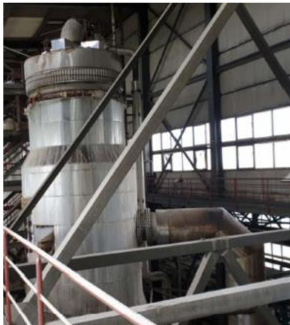
**Bild 51:** Solenkonzentrator (links) und Solenkristallisator (rechts) der Kohlemine Debiensko, aus [Xevgenos et. al. 2020].
