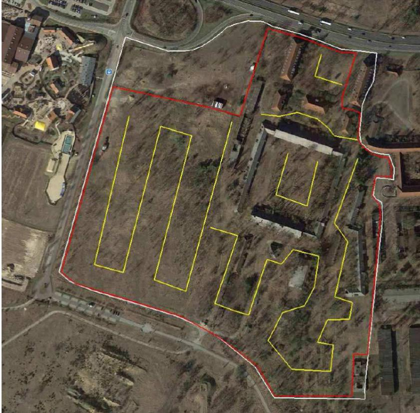
Abb. 14: Fläche der bauvorbereitenden Maßnahmen 1. BA = weiße Linie (Schutzzaun = rote Linie, Fangzäune = gelbe Linien)
