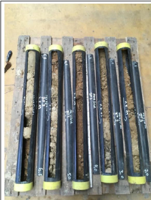
Bohrkerne von 0,0 bis 6,0 m u GOK
