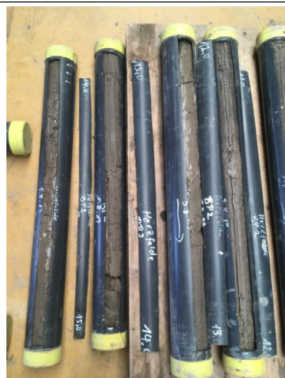
Bohrkerne von 11,0 bis 15,0 m u GOK
