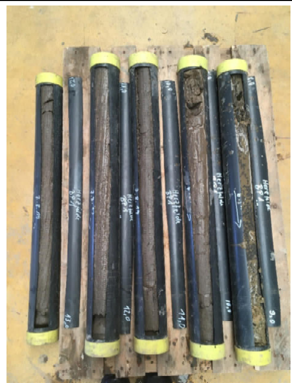
Bohrkerne von 8,0 bis 13,0 m u GOK
