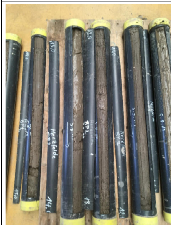
Bohrkerne von 10,0 bis 15,0 m u GOK
