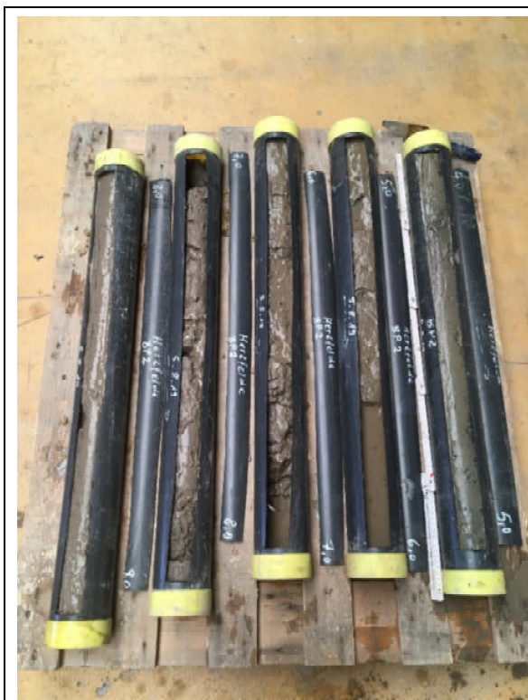
Bohrkerne von 4,0 bis 10,0 m u GOK
