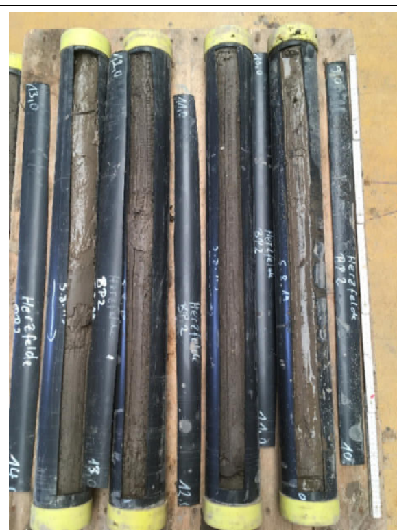
Bohrkerne von 10,0 bis 14,0 m u GOK
