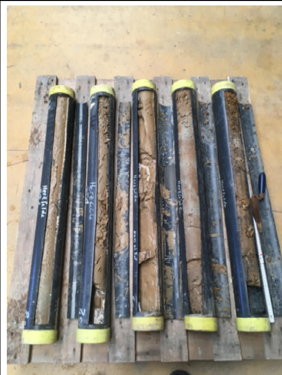
Bohrkerne von 3,0 bis 8,0 m u GOK
