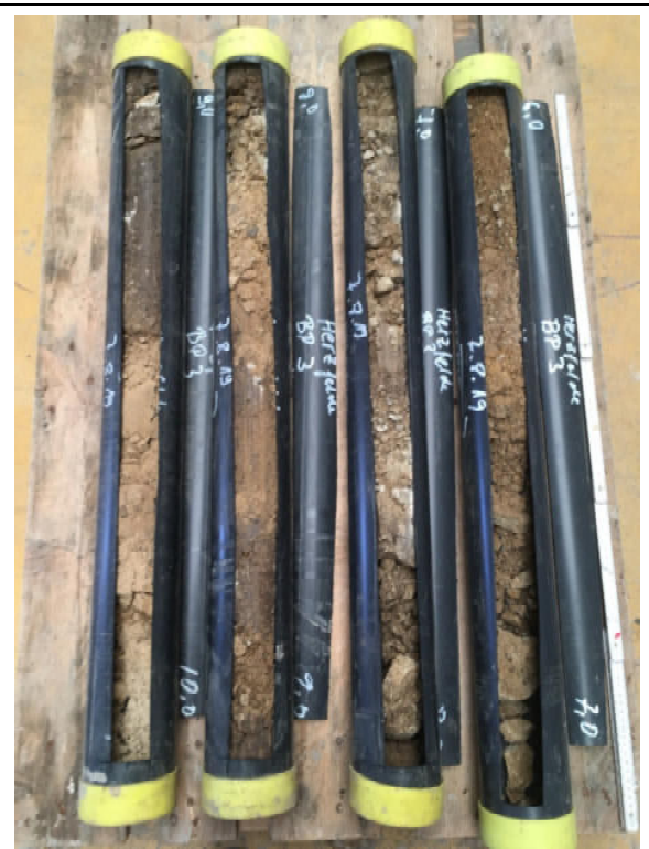
Bohrkerne von 6,0 bis 10,0 m u GOK
