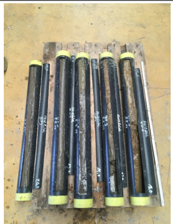
Bohrkerne von 15,0 bis 20,0 m u GOK
