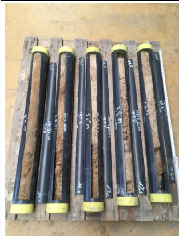
Bohrkerne von 10,0 bis 15,0 m u GOK
