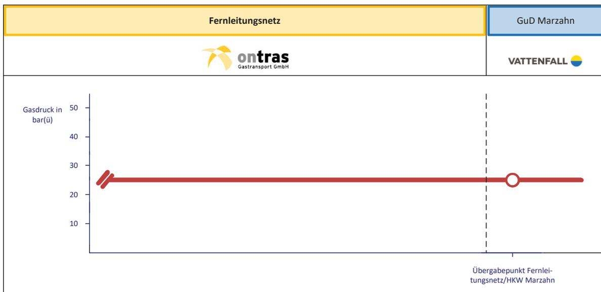
Abbildung 2: Druckverlauf nach Anschluss an das ONTRAS Fernleitungsnetz
