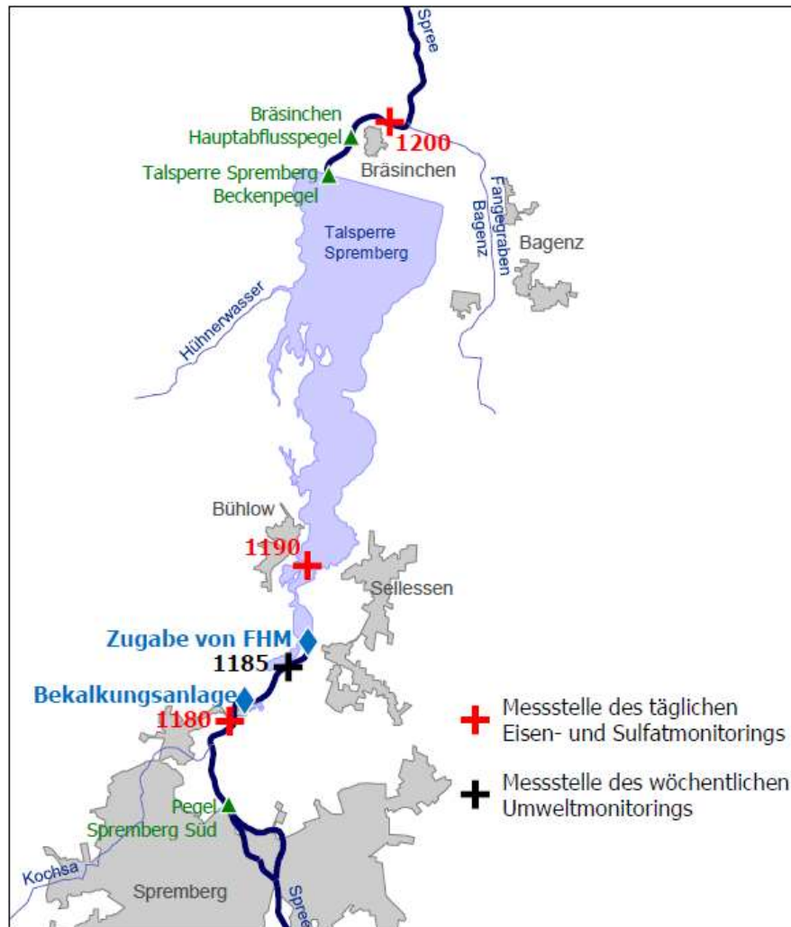
Abbildung 13: Messstellen des Eisen- und Sulfatmonitoring der LMBV /21/
