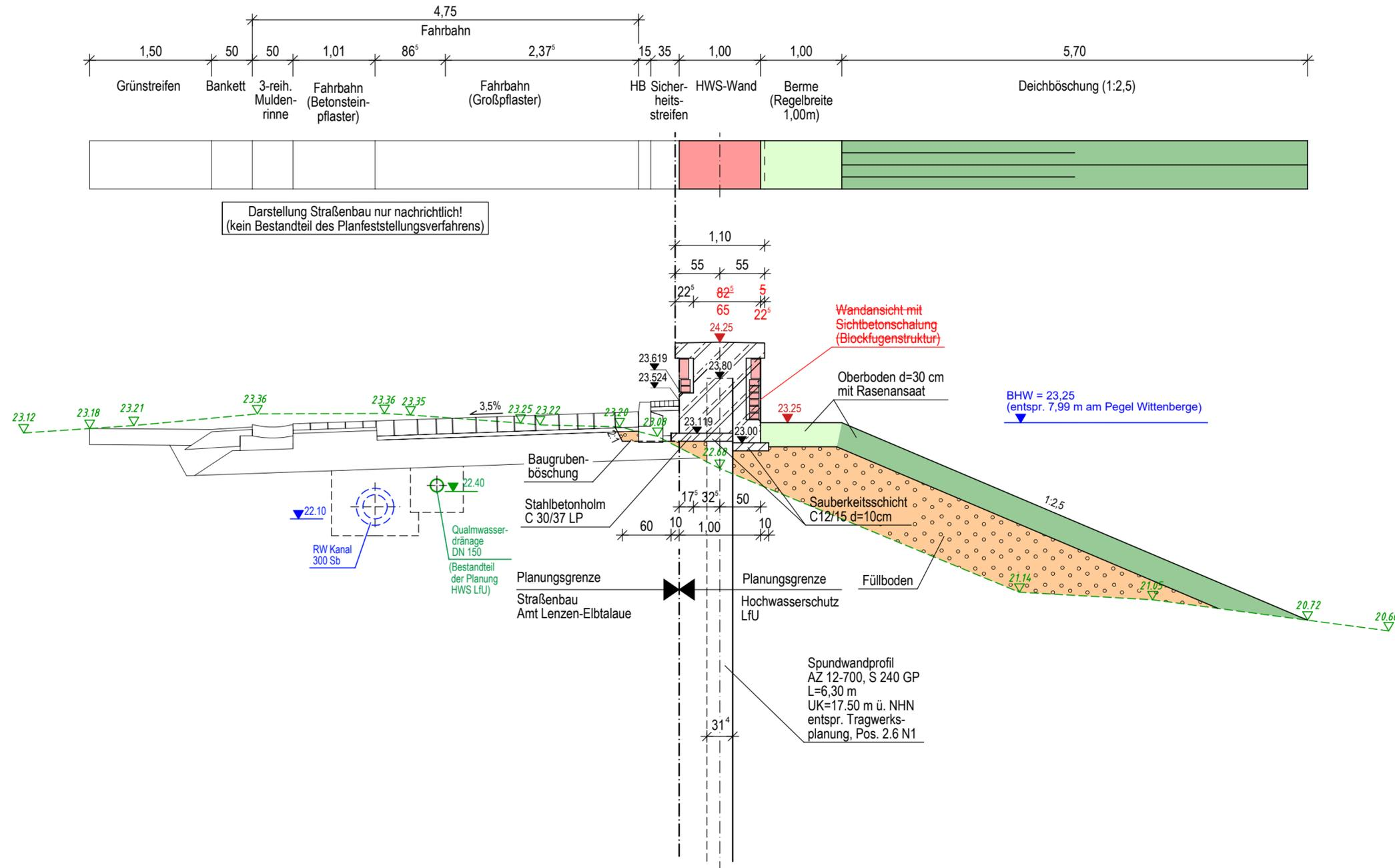
Darstellung der wasserseitigen Klinkerverblendung schematisch. Planung der Abtreppung der Mauerwerksnischen entspr. dem wasserseitigen Bermenverlauf im Zuge der Ausführungsplanung. Darstellung in den Schal- und Mauerwerkssplänen.
