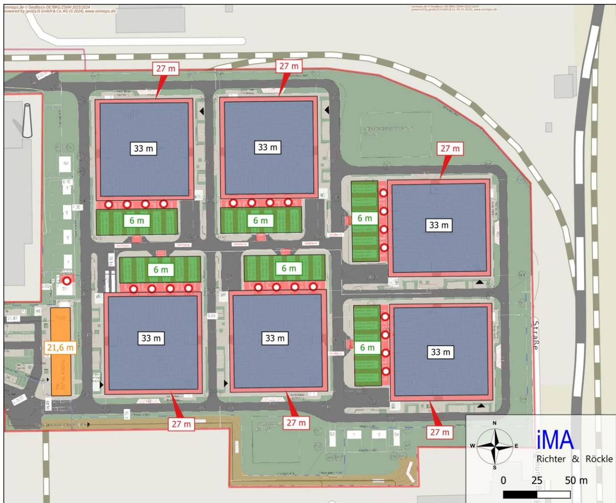
Abbildung 6-2: Höhen der Bebauung und Lage der Netzersatzanlagen sowie der Schornsteingruppen (rote Kreise).
