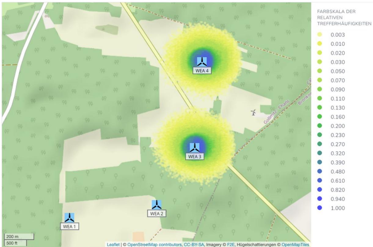
**Abbildung A.1.1:** Trefferhäufigkeiten von Eisstücken pro Rasterfläche (16m<sup>2</sup>) und Jahr in der Umgebung der WEA 3 und 4.
