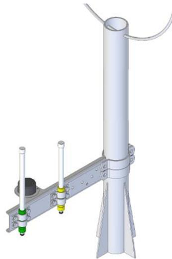
Abbildung 6: ATS-Antennen mit Montageoption an vertikaler Struktur
