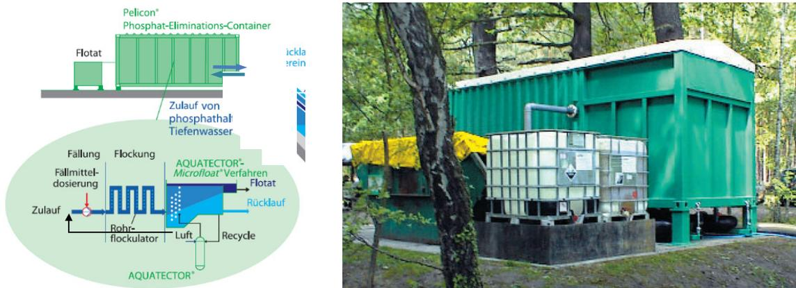
Abbildung 1: Prozessschema des PELICON®-Verfahrens (links, Quelle:/6/, verändert) und Ansicht einer Anlage für 35 m<sup>3</sup>/h Durchsatz (rechts, Quelle:/7/)
