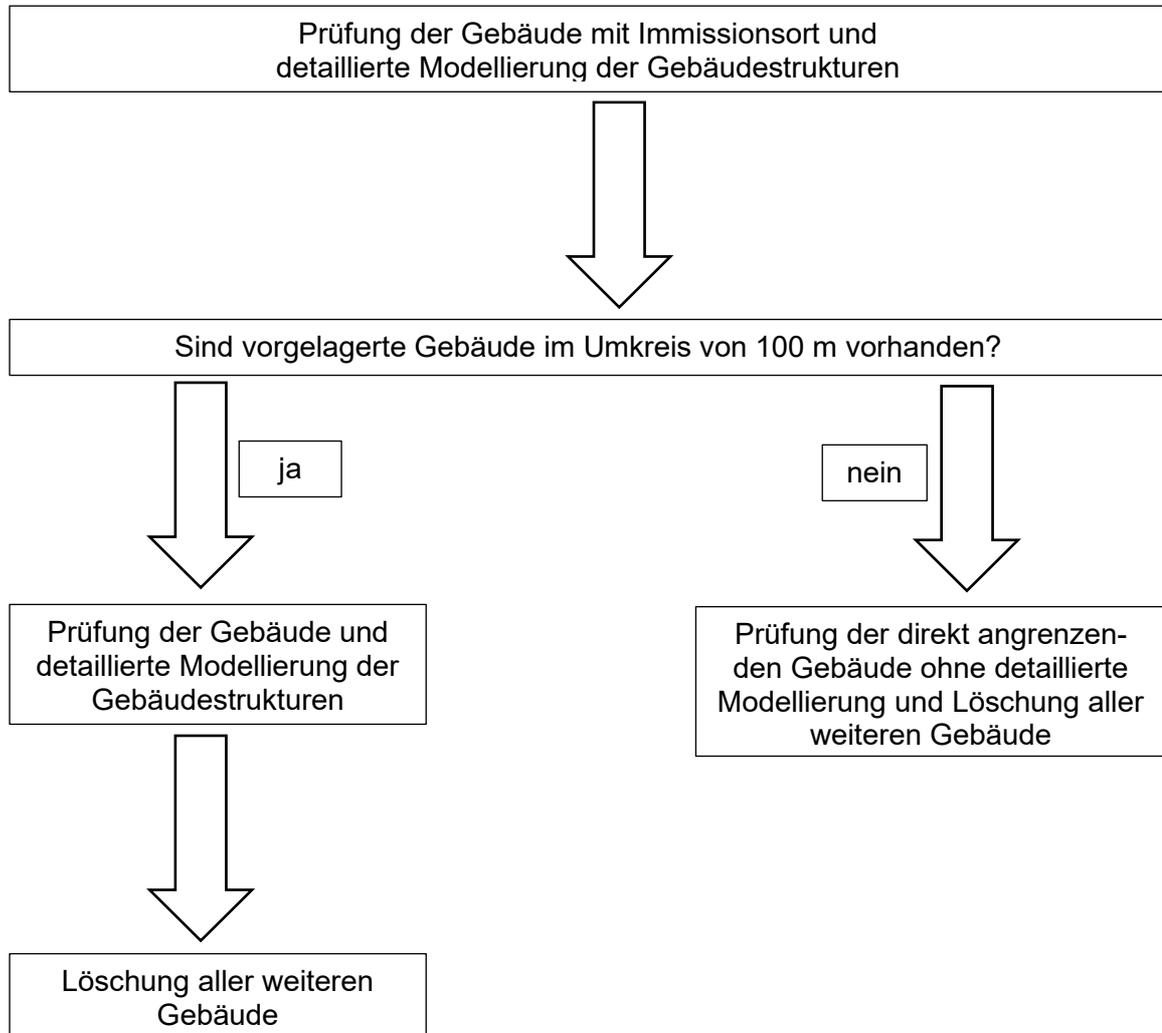
Die in der eingesetzten Software durchzuführende detaillierte Modellierung der Gebäudestrukturen beinhaltet die folgend benannten Schritte.
