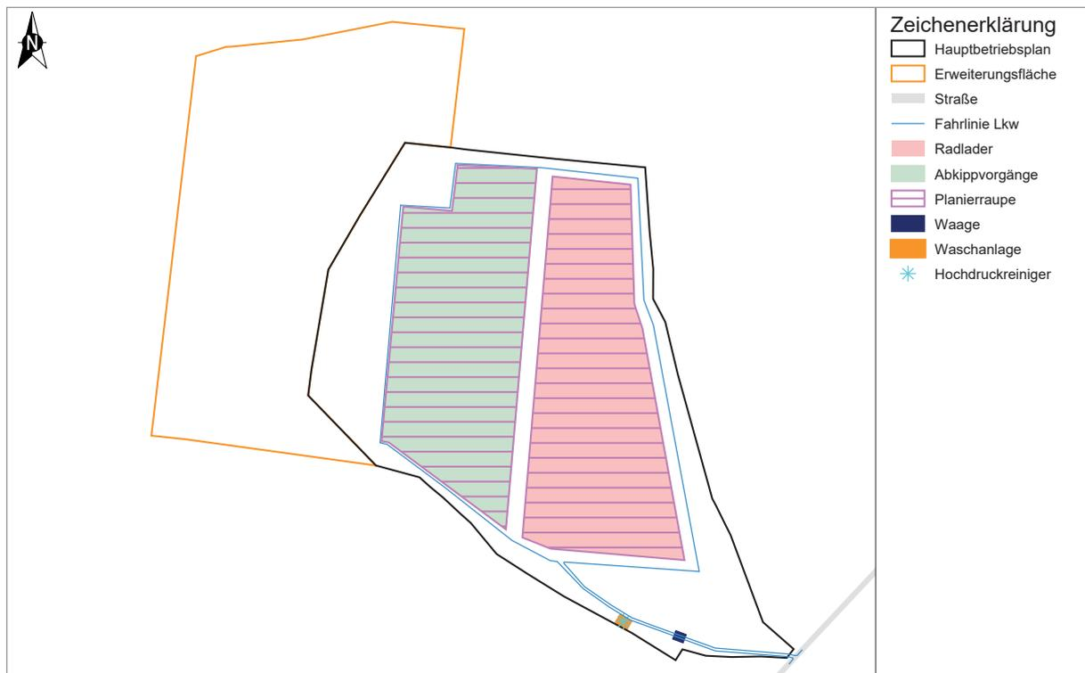
**Abbildung 3-2** Übersicht Anlagenschallquellen für den Deponiebetrieb (Zusatzbelastung)
