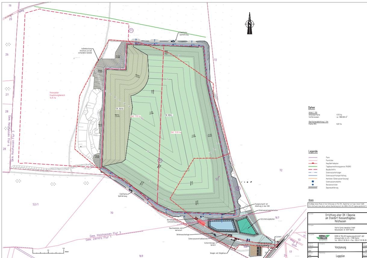
Abbildung 4-1 Lageplan mit Darstellung des Bau- und Verfüllablaufs (Quelle: Horn & Müller Ingenieurgesellschaft mbH, Stand: 21.12.2018)
