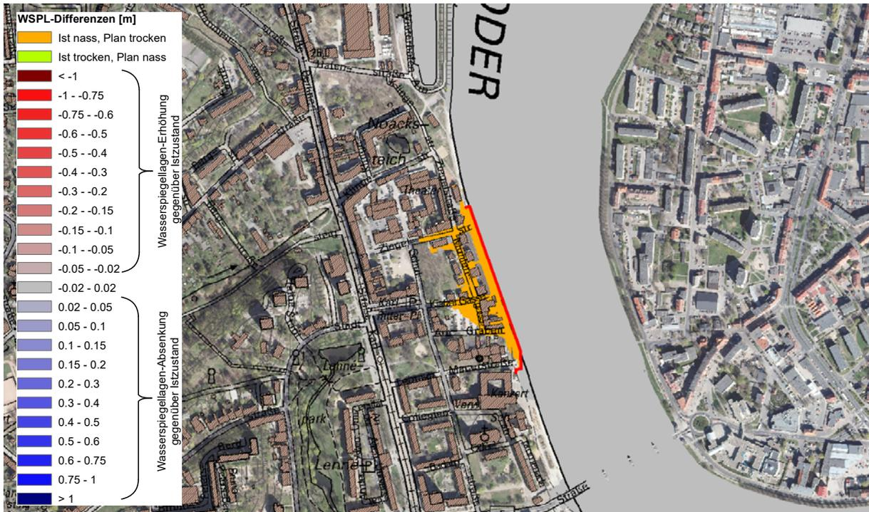
Abb. 5-7: Wasserspiegeldifferenzen HW<sub>20</sub>; Referenzzustand minus Planzustand Nord
