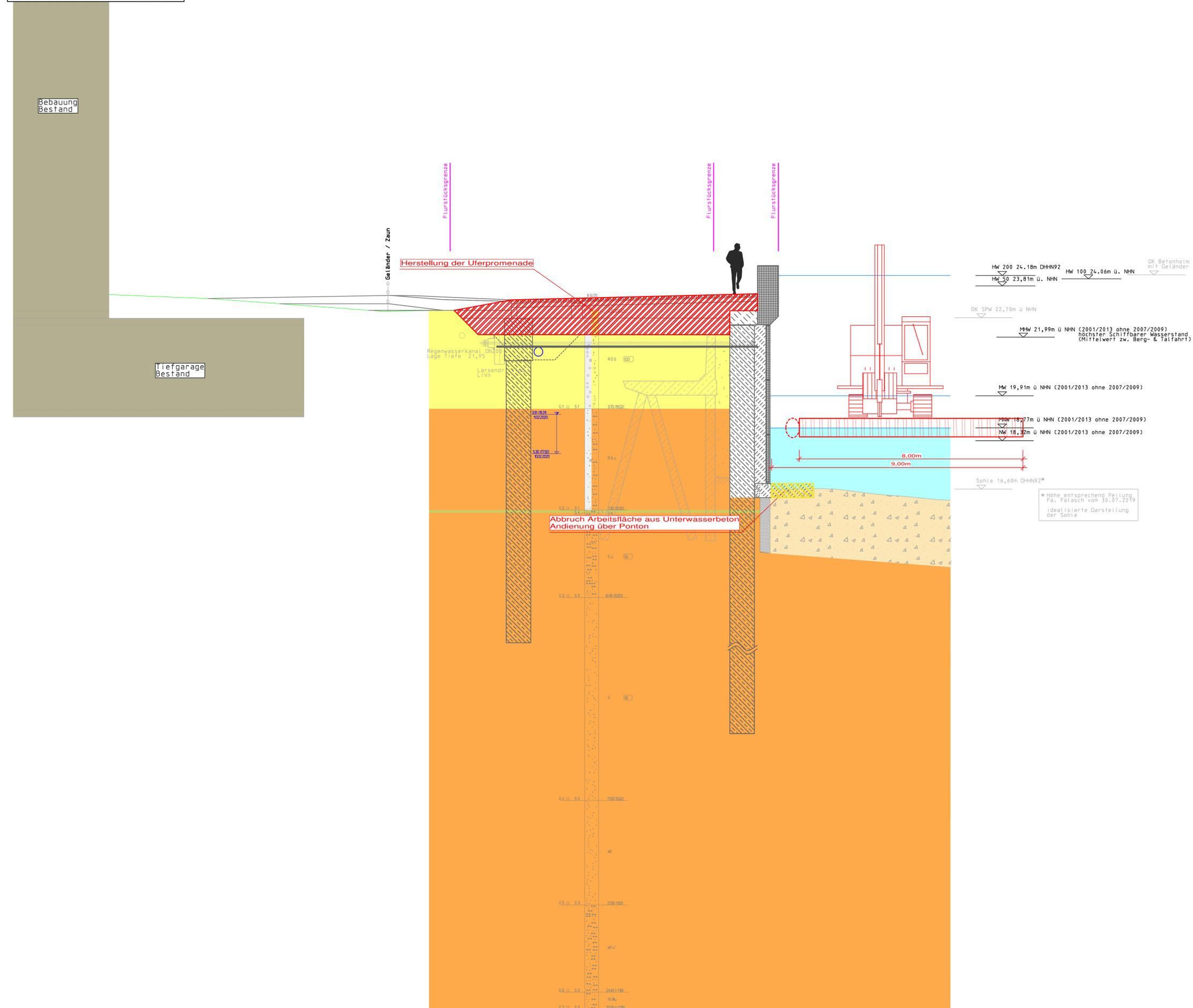
Der Bemessungswasserstand HW200 resultieren aus der Interpolation zwischen dem Pegel Frankfurt (Oder) und dem Pegel Kietz auf Basis der hydrologischen Fachauskunft des LFU, W12 vom 30.08.2017. Der Freibord von 0,35 m muss addiert werden.
