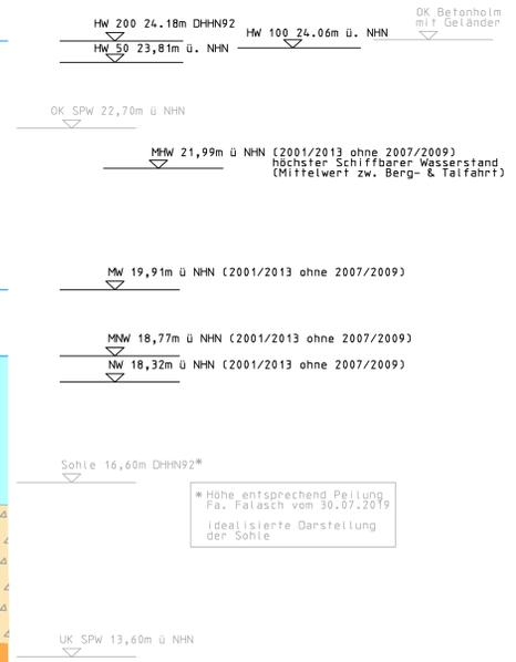
Der Bemessungswasserstand HW200 resultieren aus der Interpolation zwischen dem Pegel Frankfurt (Oder) und dem Pegel Kietz auf Basis der hydrologischen Fachauskunft des LFU, W12 vom 30.08.2017. Der Freibord von 0,35 m muss addiert werden.
