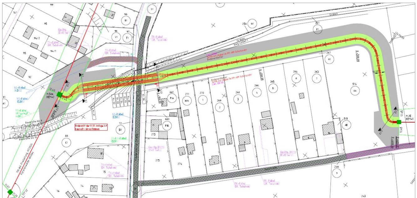
Abb. 19 - Kabeltrasse mit Kabelschutzrohranlage zwischen M58n und M2En
