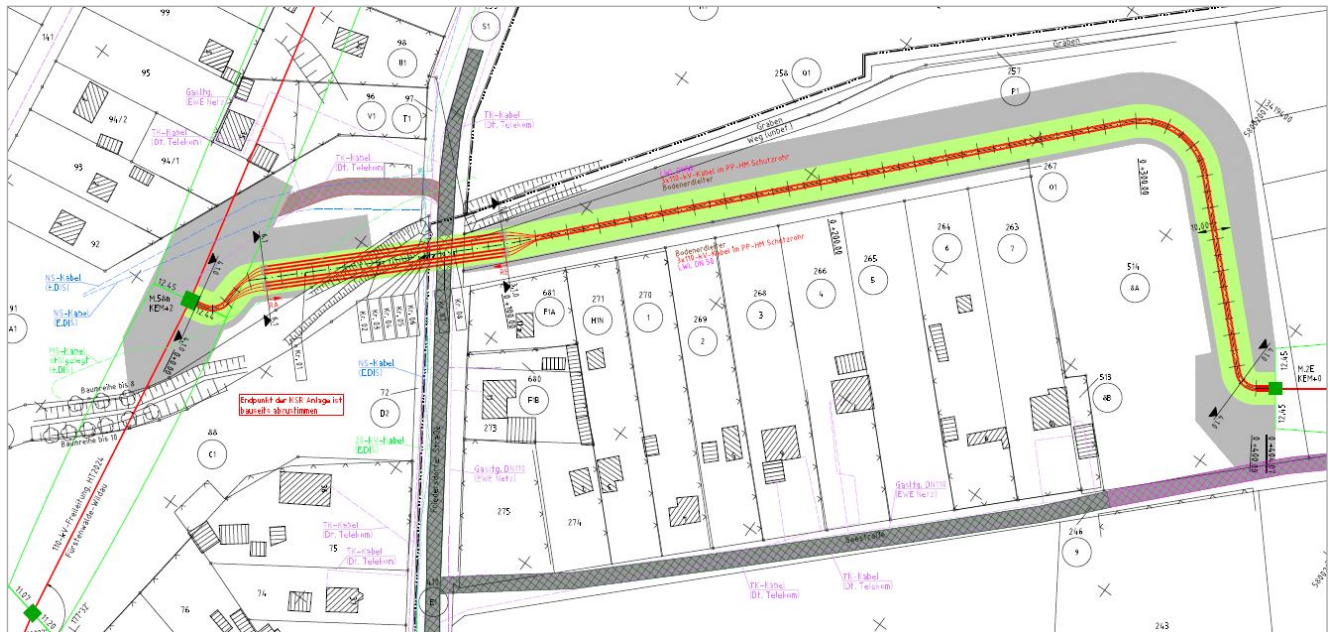
Abb. 8 - geplante Einbindung Abzweig Erkner in die Hauptleitung am neu errichteten Mast 58n mittels zwei 110-kV-Kabelsystemen
