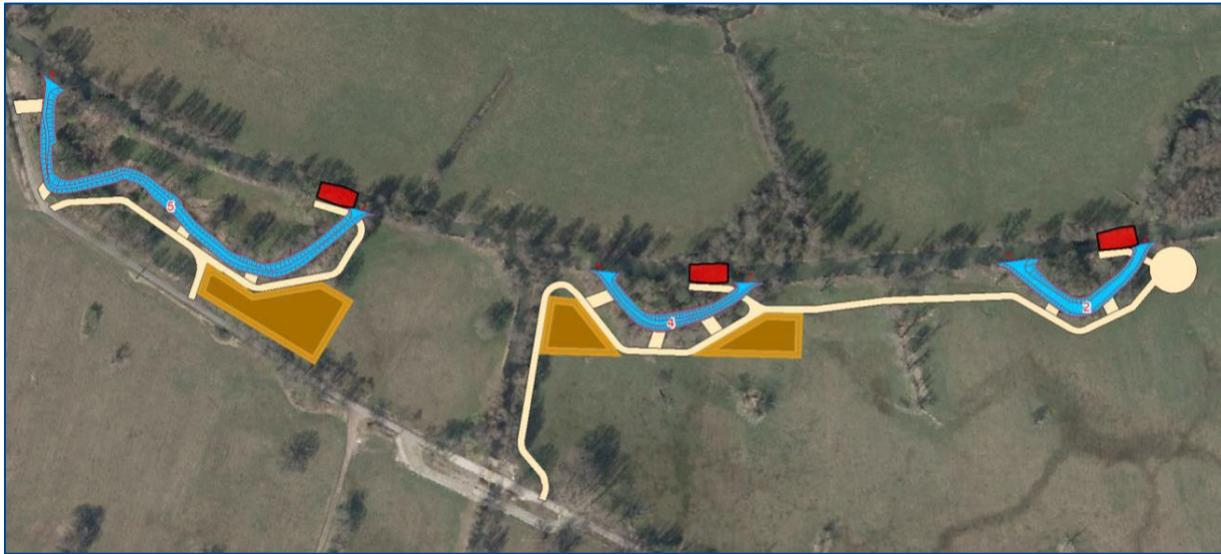
Abbildung 4.4: Bauzuwegung und Entwässerungsbecken
