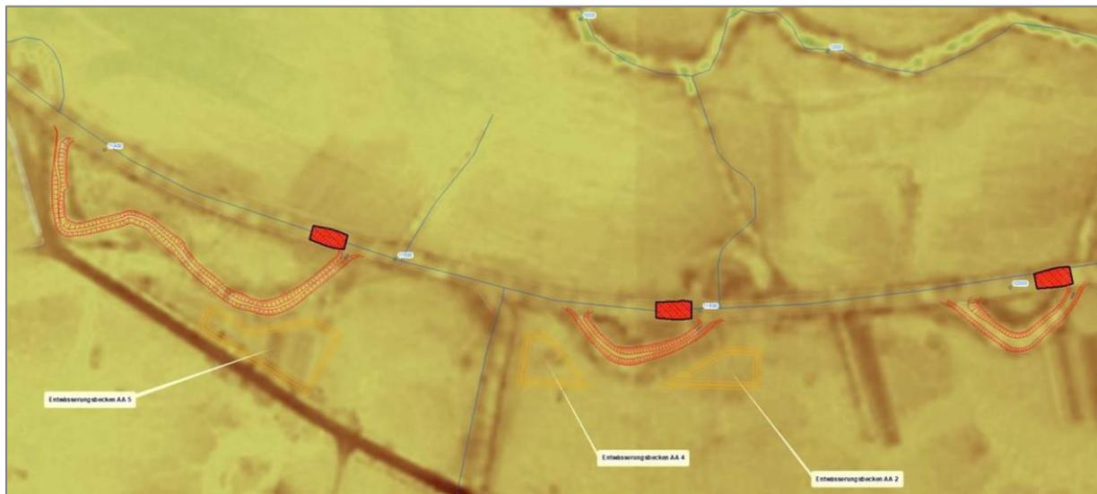
Abbildung 4.3: Wiederherstellung linksseitiger Verwallungen (Digitales Geländemodell (DGM), Grundlagendaten Geobroker Land Brandenburg), rot = Vermessung Altarme und Überlaufschwelle, gelb = geplante Lagerflächen
