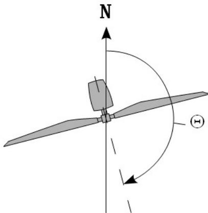
*Abbildung 2.3.4.1: Definition des Azimutwinkels  $\Theta$ .*
