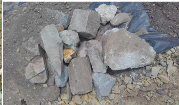
Ein Auftreten großer Blöcke ( $> 630$  mm) kann nicht ausgeschlossen werden, insbesondere unterhalb der hergestellten Abgrabungssohle von  $+79,5$  m NHN.
