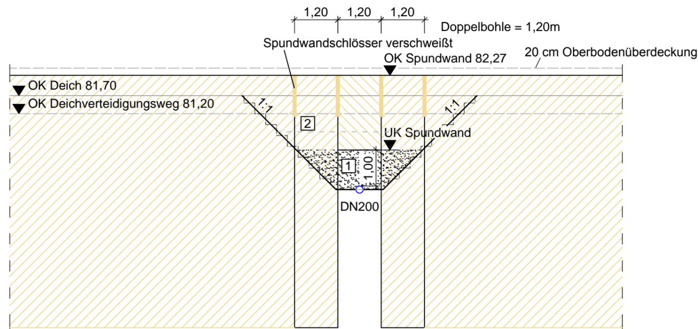
2 lagenweiser Einbau und Verdichtung des Deichmaterials  $D_{pr} > 97\%$  homogen bindiger Erdstoff  $D_{pr} > 97\%$ ,  $10^{-7} < k_f < 10^{-8}$  m/s
