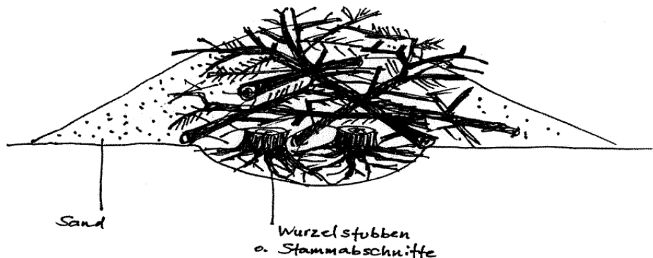
Abbildung 2: Prinzipskizze Eidechsenwall (Natur+Text GmbH)
