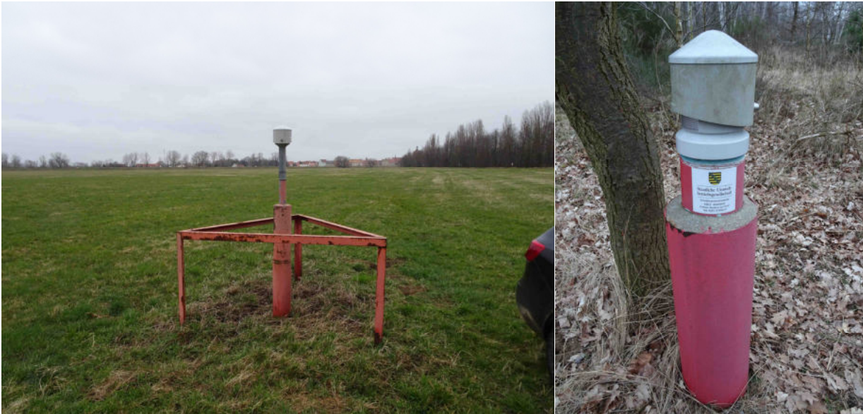
Abbildung 2–5: Grundwassermessstellen mit Datenfernübertragung der Grundwasserstände
