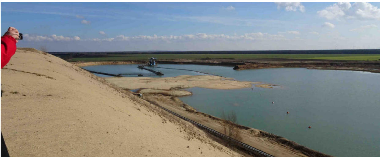
Abbildung 2-2: Westliches Abbaufeld mit Schwimmbagger und Rückverspülung
