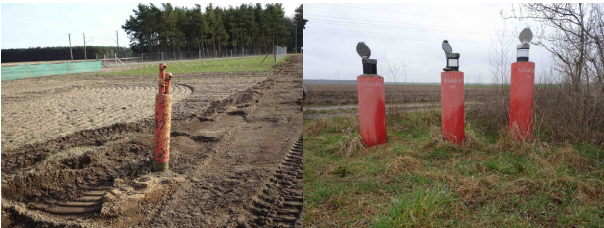
Abbildung 2–4: Beispiele mehrfach ausgebauter Grundwassermessstellen
