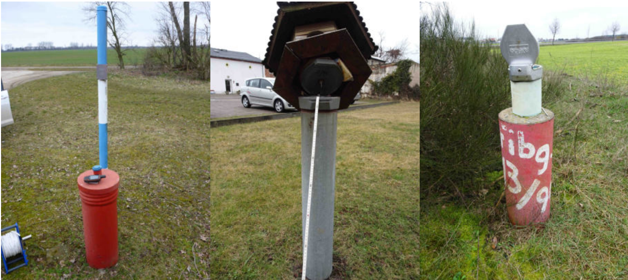
Abbildung 2–3: Beispiele von einfach verfilterten Grundwassermessstellen
