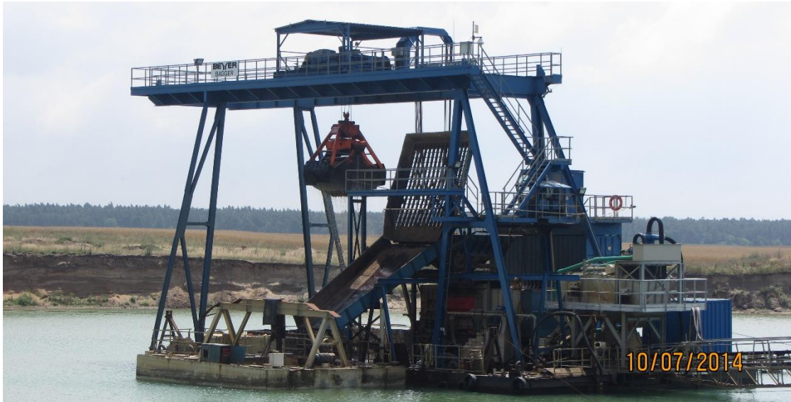
Abb. 2: Schwimmbagger mit Gewinnungsböschung im Hintergrund
