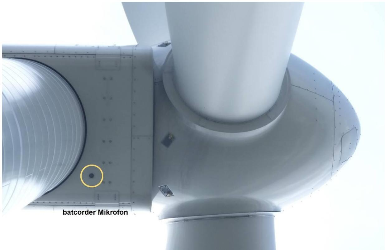
Abbildung 2: Position des Ultraschallmikrofons an einer VESTAS V112 für die akustische Erfassung von Fledermäusen in Gondelhöhe (Quelle: IfAÖ GmbH)
