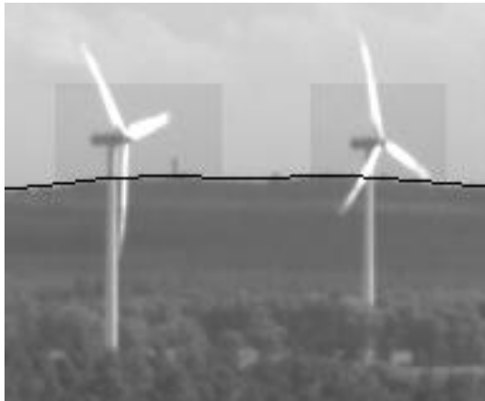
Abbildung 1: Automatisch generierte Ausschlussgebiete um Rotoren von WEA
