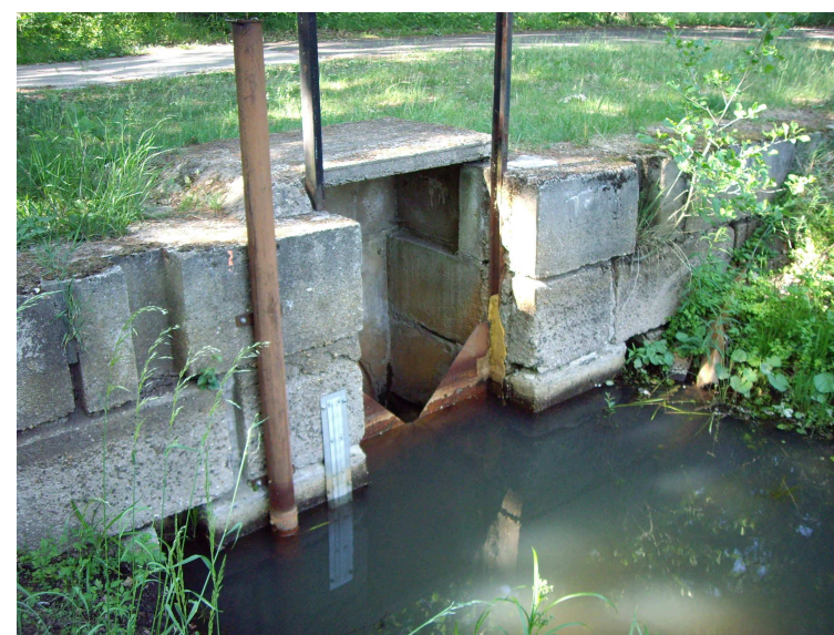
Abflusspegel MP 2, Fanggraben Thomsonwehr 90°
