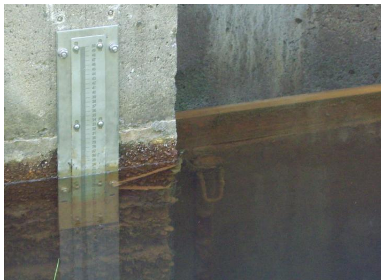
Relativ geringen Braunfärbung durch Ausfällung von \text{Fe}(\text{OH})_3 bei Abflusspegel MP 1, temporäre Eisenazidität, kristallklares Wasser mit pH-Werten zwischen 3,9 und 4,5 mittl. Leitf. (25°): 545 \mu\text{S}/\text{cm} .
