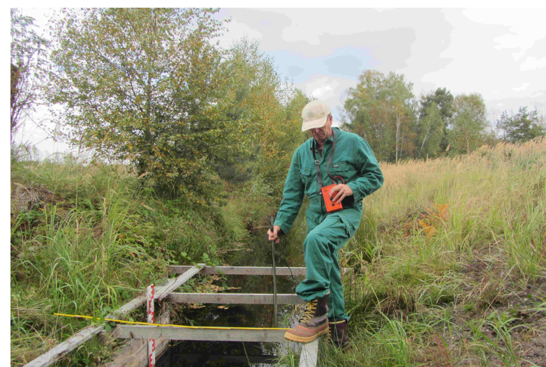
Eichmessung am MP 3, Wasserabgabe Gewinnungsteich
