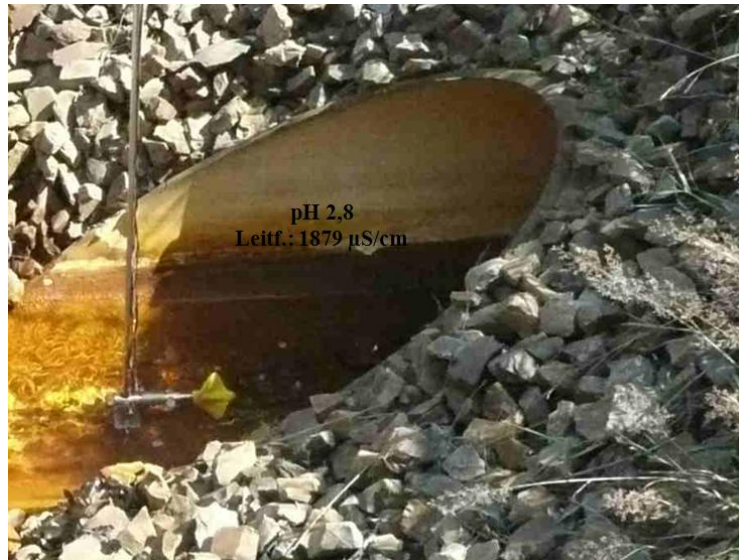
Braunfärbung durch Ausfällung von \text{Fe}(\text{OH})_3 im Abstrom des RL Heide, kristallklares Bachwasser bei MP 33 östlich der Ortschaft Peickwitz pH-Wert 2,8 Leitfähigkeit (25°): 1879 \mu\text{S}/\text{cm} .
